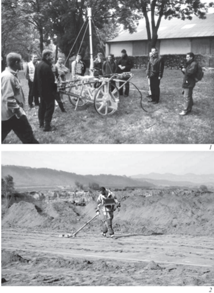
Рис. 2. Модель градиентометра с цезиевыми датчиками (1); модель георадара с периферийными устройствами записи (2) (по: Бездудный, 2006. Рис. 7)
