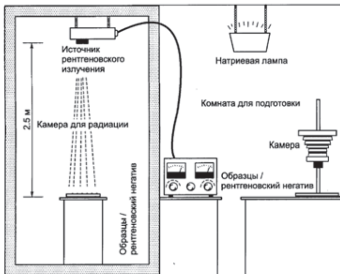
Рис. 1. Схема подготовки и облучения древесных образцов мягким рентгеновским излучением для проведения денситометрического анализа (по: Schweingruber, 1988; Шиятов и др., 2000. С. 57)
